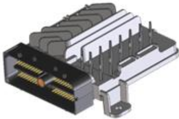
fig 1. På bilden ser du den senaste typen av Allison TCM, den så kallade GEN 5 TCM.
